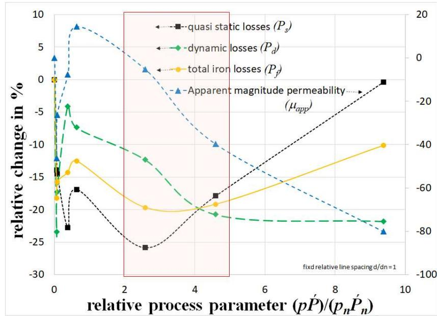
Fig. 4 : Magnetic results @1.5T@50Hz v.s.  $p\dot{P}$ .
