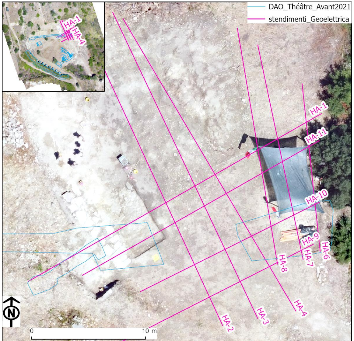
Figura 9-Ubicazione degli stendimenti realizzati; in azzurro viene riportata la traccia dei rilievi effettuati dalla missione archeologica francese (base: ortofoto georeferenziata da rilievo da drone)
