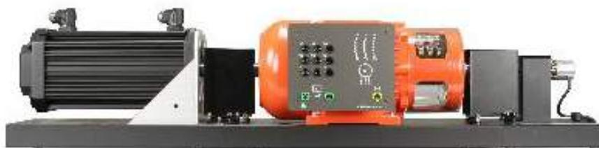
FIGURE 80 – Emulateur éolien : partie puissance
